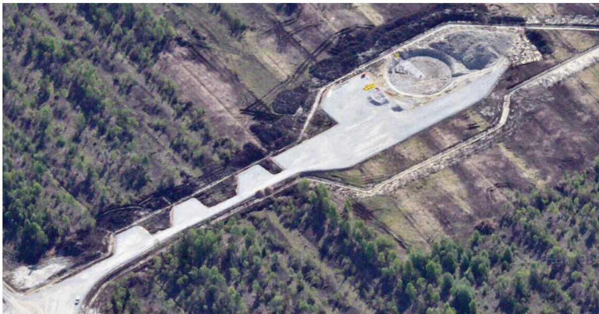
Attēls5 . Iespējamā vēja turbīnu pamatu platība ar montāžas vietām. Avots: Zemes pārvaldes aerofotoattēls – Tootsi/Sopi vēja parks. Montāžas vietas precīzā forma un platība ir atkarīga no vēja turbīnu ražotāja specifikācijām.
