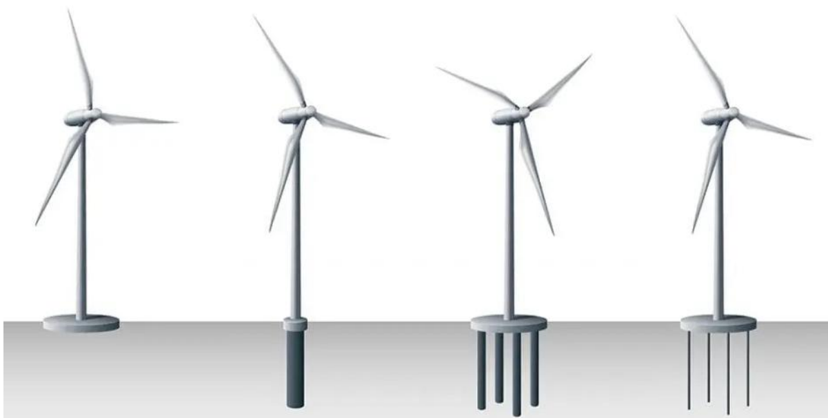
Attēls4 . Vēja turbīnu pamatu veidi 13 . No kreisās puses: gravitācijas pamats, vienkāršu pāļu pamats vai monopāļu pamats, plātnes pamats ar kombinētiem pāļiem, plātnes pamats ar kombinētiem enkuriem.
