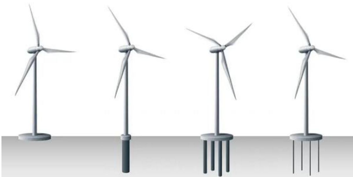
4 . Vēja turbīnu pamatu veidi 17 . No kreisās puses: gravitācijas pamats, vienkāršu pāļu pamats vai monopāļu pamats, plātnes pamats kombinācijā ar pāļiem, plātnes pamats kombinācijā ar enkuriem.
